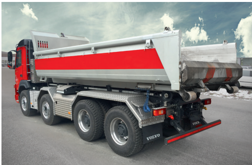
Sörlingklappe, hochgezogene Stirnwand
